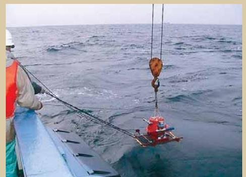
■福岡県西方沖地震の震源域直上の海域に投入される自己浮上式海底地震計
