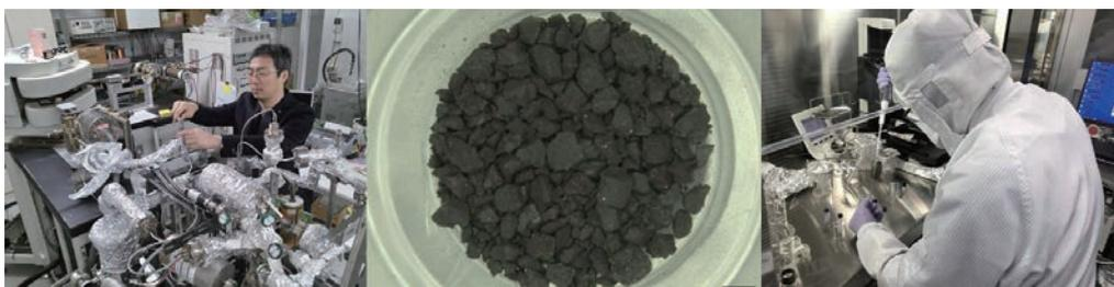
(左から、希ガス同位体質量分析計、分析した小惑星リュウグウ粒子、クリーンルームでの有機物抽出作業)
