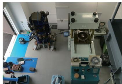
伊都キャンパスの地球深部実験室に設置された高压変形装置
