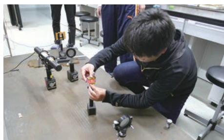
レーザーを用いた光の干渉実験
