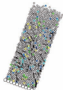
斜面を流れる粉体のシミュレーション。粒子同士の相互作用力が、粒子間を結ぶ線によって示されている。
