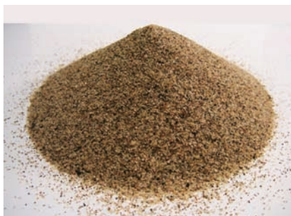
乾いた砂山の表面は、なめらかな斜面をつくる。この傾斜よりも表面を傾けると、砂は流れ出す。
