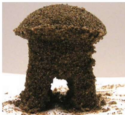
粉体を湿らせると、粒子間に引力が働いて振る舞いが大きく変わる。
