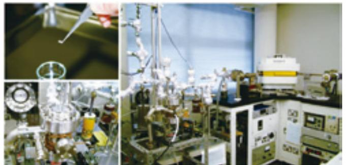
隕石試料を入れるアルミカップ(左上)、試料を加熱するミニ炉(左下)、希ガス同位体を測定する質量分析装置(右)
